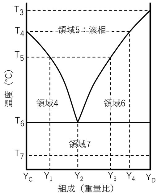
図2 固相c-固相dの相平衡図
