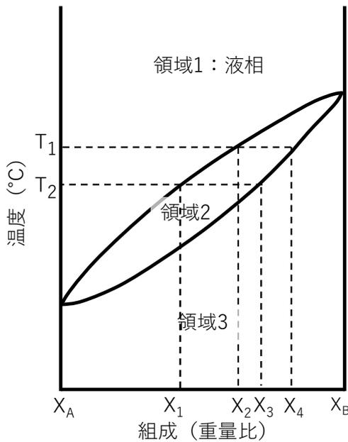
図1 固相aの相平衡図
