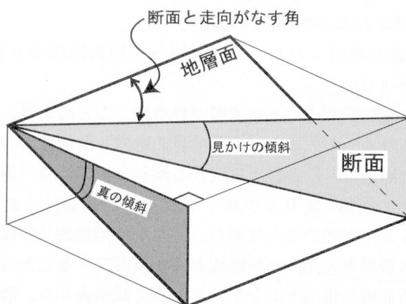
**図 2** 地層面の見かけの傾斜 (日本地質学会編, 2004)
