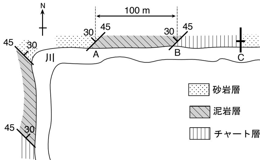
図1 作成したルートマップ(平面図)
