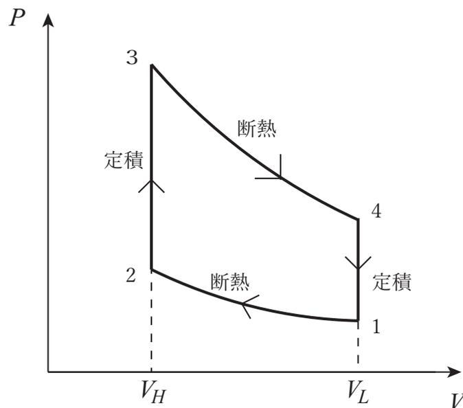
図 1 オットーサイクルを、横軸を体積  $V$ 、縦軸を圧力  $P$  として表現したもの。
