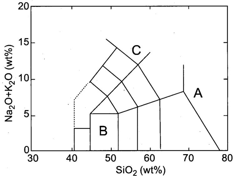
図1  $\text{Na}_2\text{O}+\text{K}_2\text{O}$  と  $\text{SiO}_2$  を用いた火山岩の分類図
